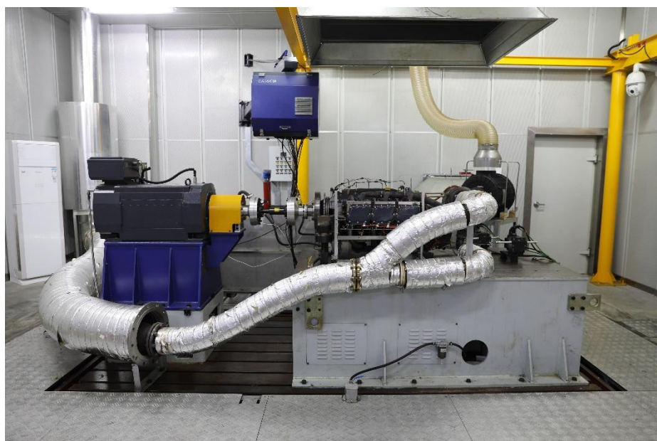
图 2 功率吸收装置及台架整体示意图
